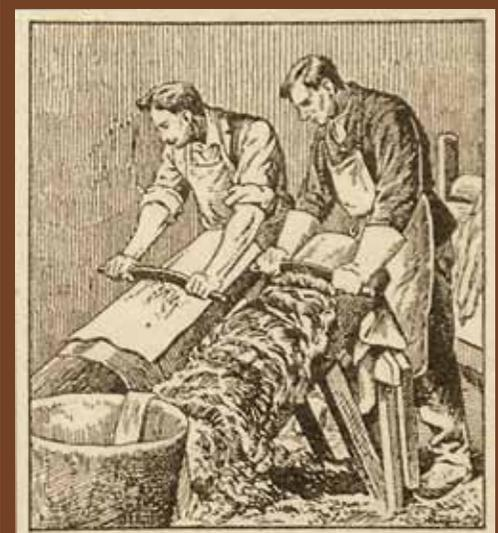
**4- Débourage ou épilage** : arrachage des derniers poils. Les poils recueillis forment la « bourre » utilisée par les tapissiers pour garnir meubles et sièges.
